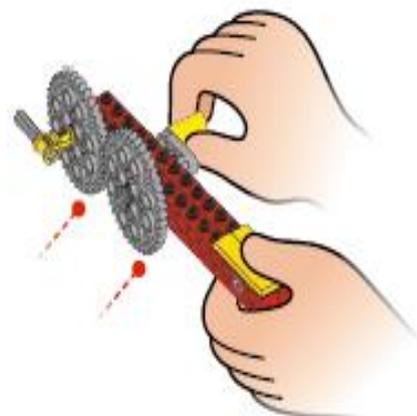
3. Испытайте модель и зафиксируйте результаты наблюдений. Поверните ручяжку на один полный оборот и посчитайте, сколько раз повернется маркер положения. Ответ запишите здесь:
